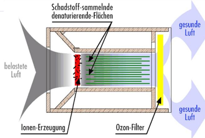
Durch sein neuartiges Filtersystem ist die Wartung, anders als bei konventionellen Luftreinigungsgeräten, unproblematisch und kostengünstig. Da die Keime im Filter nicht nur gesammelt, sondern abgetötet werden, kann der alte Filter gereinigt oder im Hausmüll entsorgt werden.
